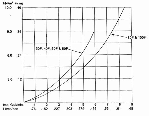
FIG. 5 PRESSURE LOSS ACROSS BOILER
